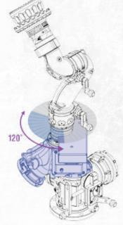
BOOSTER OSCILLATION MODULE OSCILLATES MONITOR UP TO 120 DEGREES
