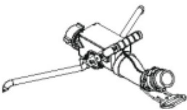
Малогабаритный, т.к. имеет один поворачивающийся вход и 2 раздвижные опорные ноги с твердосплавными наконечниками.
