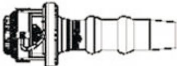
Дополнительно ствол **MASTER-STREAM** обеспечивается пенным насадком **FJ-LX-M** (см. рис. слева) для пены низкой кратности (1:10).
