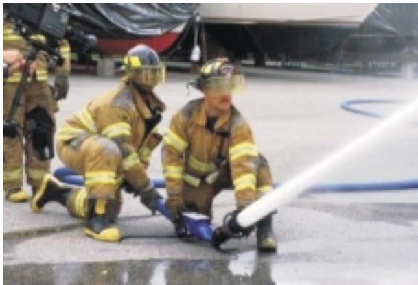
**BLITZFIRE** (БЛИЦФАЙЕ) – переносной лафетный ствол (для заказа: **XX111A**) с автоматическим стволов-насадком **MAX-FORCE** (МАКС-ФОРС) работает при двух давлениях: стандартном давлении  $7 \text{ кгс}/\text{см}^2$  и пониженном давлении  $4 \text{ кгс}/\text{см}^2$ .
