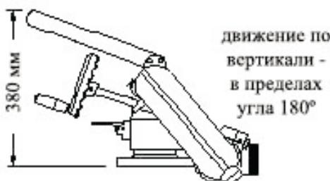
Фактически это «колено» переносного лафетного ствола КРОССФАЙЕ (сравните рис. слева и часть 2 на стр. 4) с фланцевым входом и видоизмененной ручкой.
