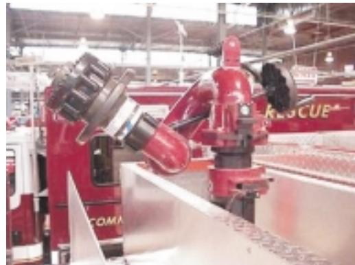
Лафетный ствол комплектуется также гладкоствольными спрысками **MST-4NJ** (4 шт.), успокоителем **XF-SS10** для увеличения дальности подачи и необходимым креплением **XF-B** для фиксации ствола в отсеке автомобиля.
