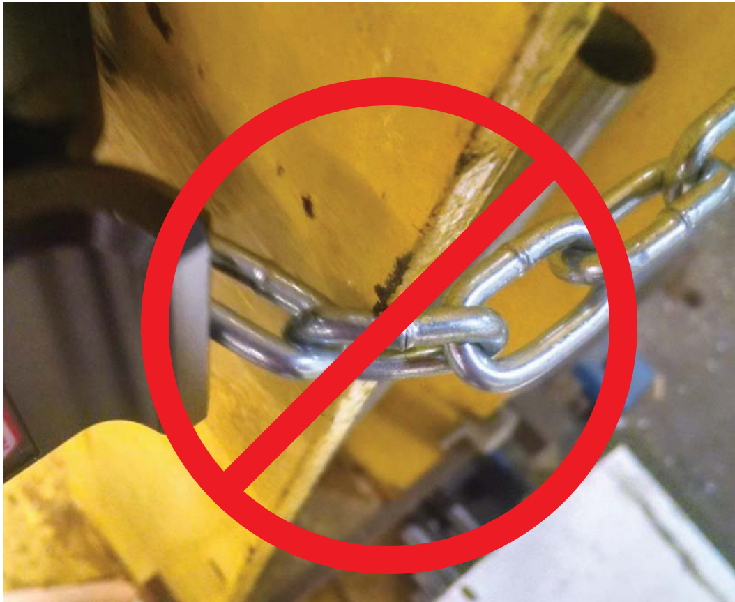
Figura 2.17 Debe evitar doblar la cadena en esquinas.
