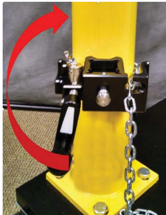
Abb. 2:26 Spannen der Kette
