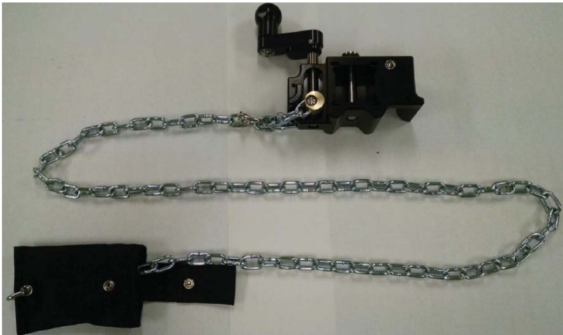
Abb. 2.23 Kette von Tasche getrennt und kontrolliert
