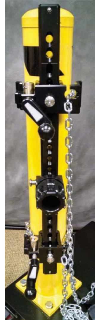
Abb. 2.30 Montage der Querstiftbefestigungshalterung
