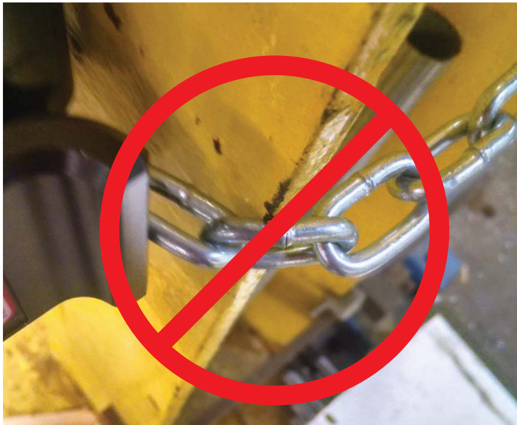
Abb. 2.17 Vermeiden Sie das Verbiegen der Kette an Ecken.
