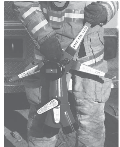
Figura 4.2.3 Los dos pares de piernas abiertas y atrancadas en posición.
