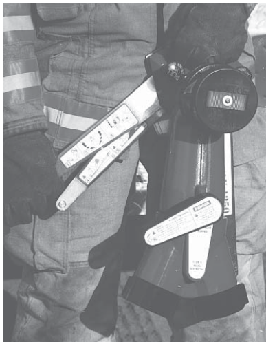
Figura 4.2.1 Detenga la base deteniendo el mango y agarre una de las piernas largas.
